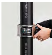
Växeldra de två bultarna med exempelvis en spärrnyckel. Monteringen är korrekt utförd när bultförbanden möts.
