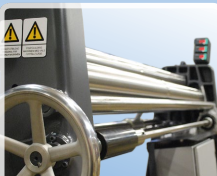
Konbockningsutrustning: inkluderar snedställning av böjvals, släpsko samt handratt med räkneverk
