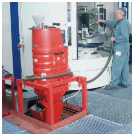
DS 1220 som silosug i metallproduktion
