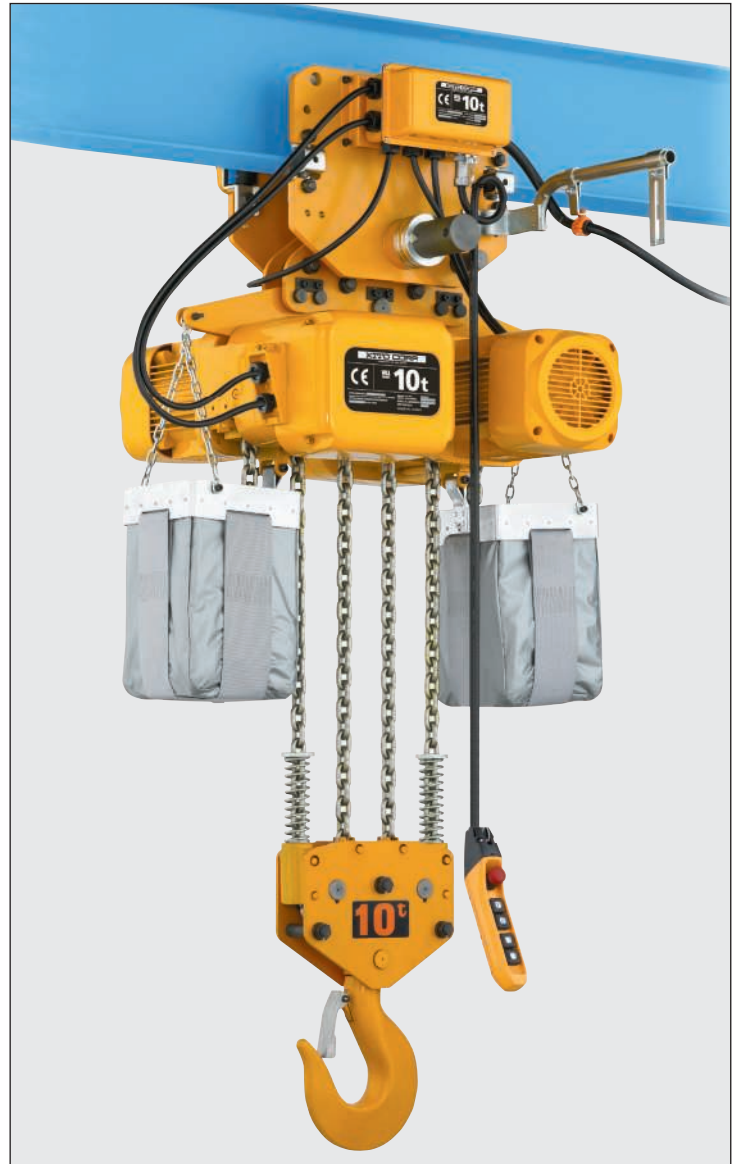
KITO Royal ER2 10000/4S monterad i elåkvagn typ MR med två valfria åk hastigheter, 4–24 m/min.
