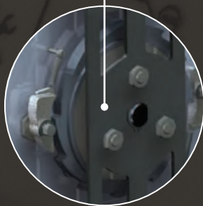
2 x oberoende bromsspärrar och SBM-förseglad bromsmodul
