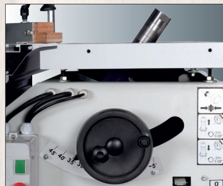
S Naklonení hřídele -5°, 0°, 45° Spindle tilting -5°, 0°, 45° Spindelschwenkung -5°, 0°, 45° Inclinación del eje -5°, 0°, 45° Inclinaison de l'arbre -5°, 0°, 45° Наклон шпинделя -5°, 0°, 45°
