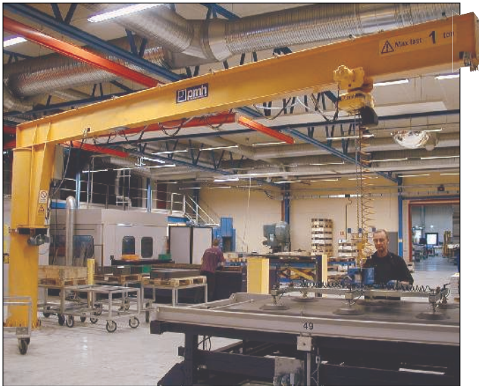
PMH Meister pelarsvängkran typ M 1000/8 med PMH Classic elektrisk kättingtelfer.
