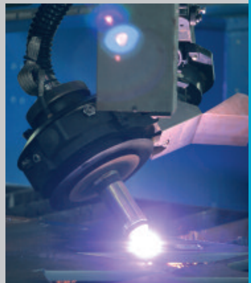
Plasma Fasenschneidaggregat Skew Axis Rotator Δ für automatische Konturschnitte
