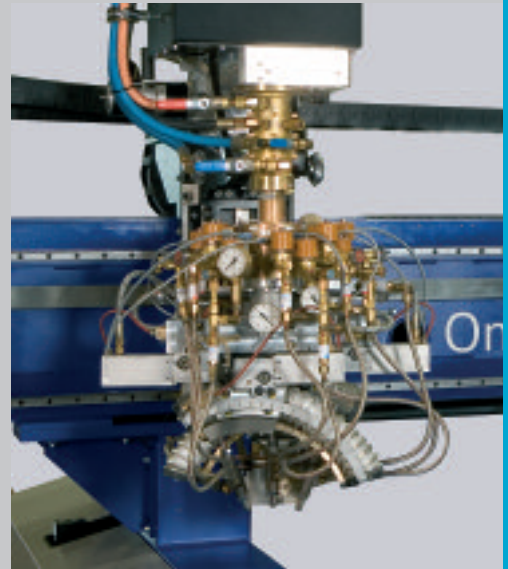
Vollautomatisches, unendlich drehbares Dreibrenneraggregat DAFL für das Autogen-Fasenschneiden an Konturen
