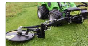
Kant-/Stolpklippare RI monterad.
