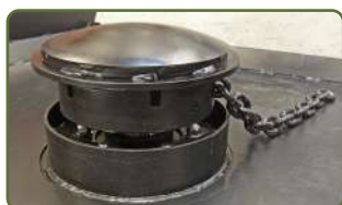
Slittalrik under kedjemagasinet.
