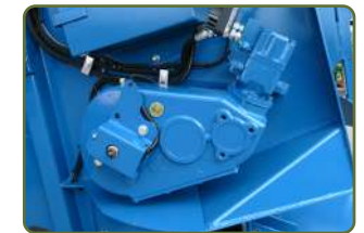
Hydrauliskt driven reversibel bottenmatta
