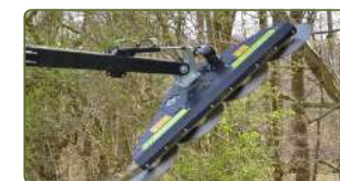
Grensåg LRS monterad. Hydraulisk klippvinkeljustering 110° (extrautrustning HXF 3302). Kräver 1 st dubbelverkande hydrauluttag.
