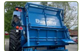
Hydraulisk öppningsbar baklucka
