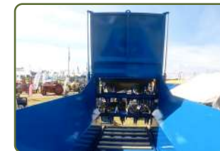
Dubbelverkande hydraulisk giljotindörr
