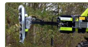
Grensåg LRS monterad, extrautrustad med motvikter.
