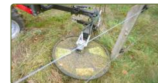
Kant-/Stolpklippare RI monterad.
