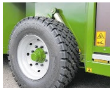
Dubbelverkande kolv som är i sitt inre läge vid körning
