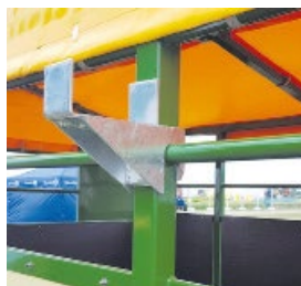
Galvade krokar för upphängning av fångstgrindar
