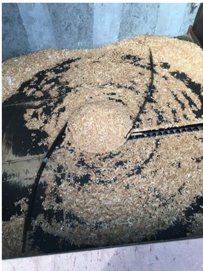
Fjäderförråd för flis och pellets samt briketter.
