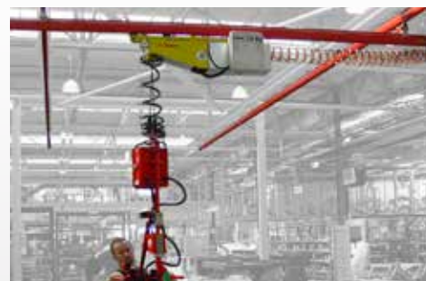
Balanslyftare monterad i åkvagn för enkelbana eller travers
