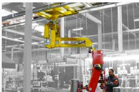
Balanslyftare med driven åkvagn
