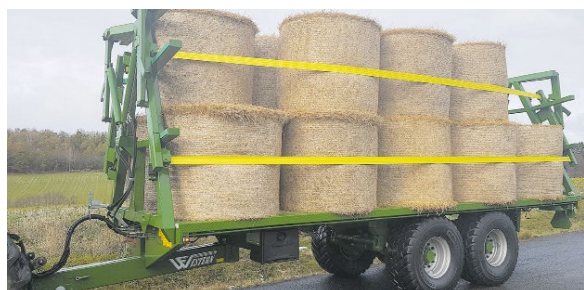
Hydraulisk ballåsning som klarar en eller två balar i bredd på andra lagret
