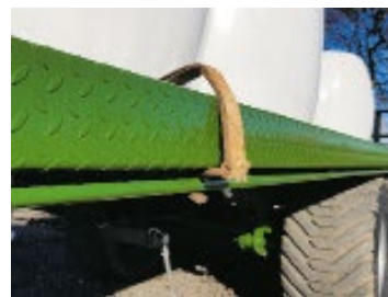
Surringsrör under kantlinan längs hela flaket
