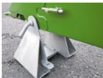
Galvaniserad, pendlande kraftig stödfot med stor markplatta
