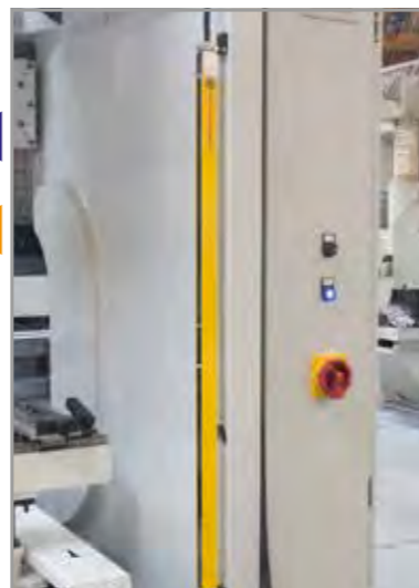
▶ Back Light Curtain Safety System ▶ Lichtvorhang auf der Rückseite
