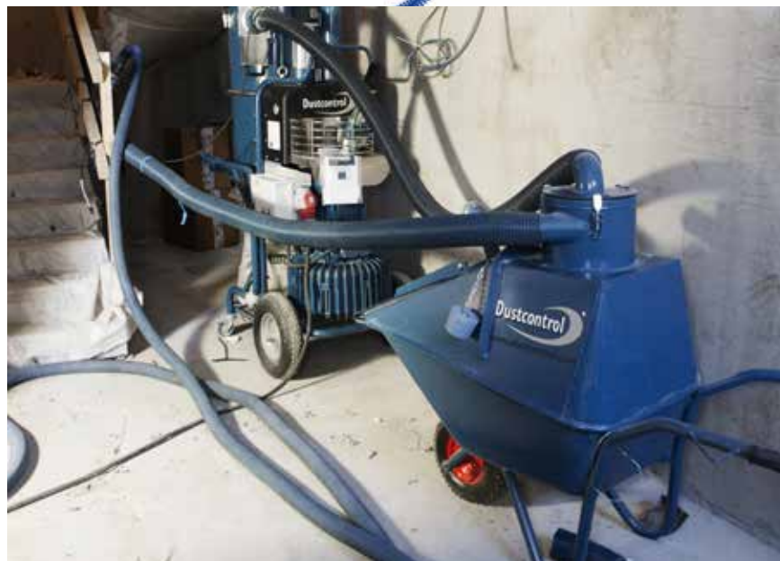
Centralenhet DC 5900, 9,2 kW P med föravskiljare DCF Skottkärra.
