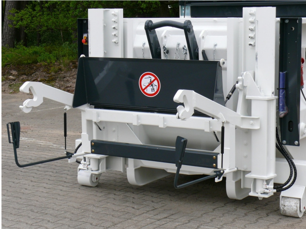
Integrerad kärltömmare med automatisk locköppning.
