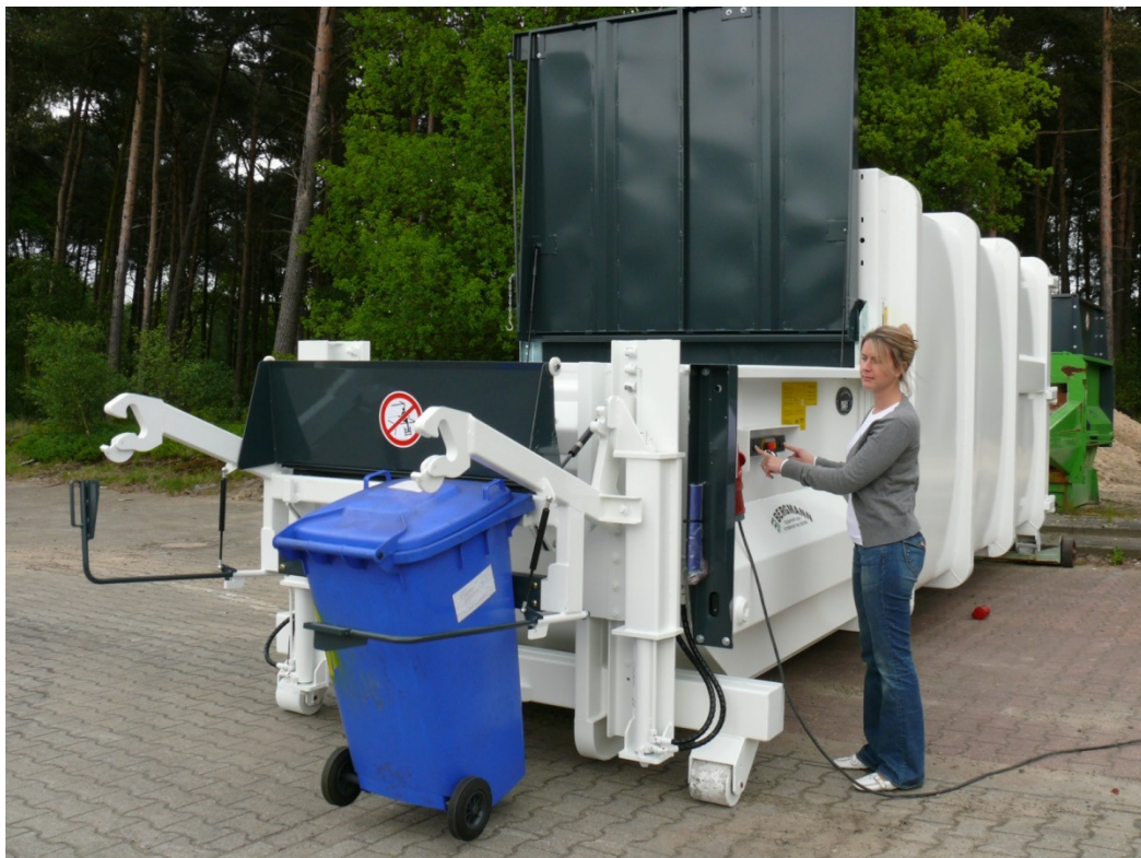
Integrerad kärltömmare med automatisk locköppning.
