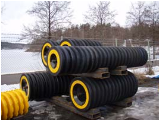
Färdigmonterade gummivältpaket i väntan på leverans.
