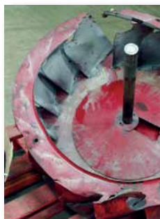
Ett fläkthjul som kom in efter ett haveri i en stor utsugsfläkt.
