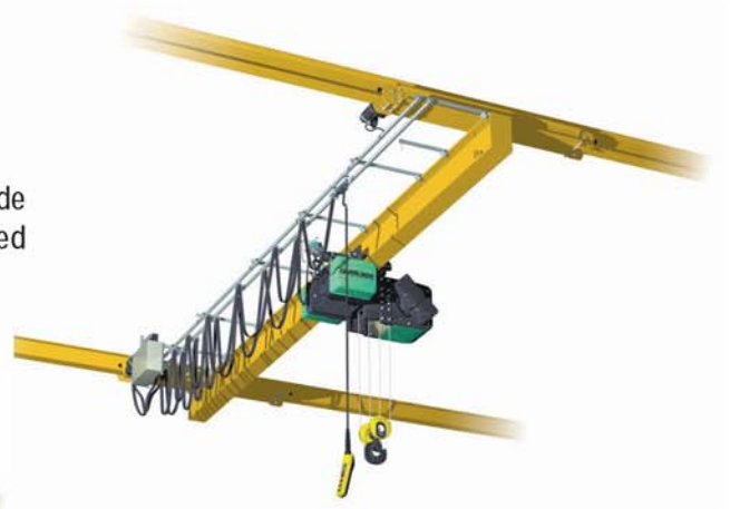
RT-1. Rålgående enbalkstravers med lintelfer. Strömförsörjning till telfer via via strömbana.
