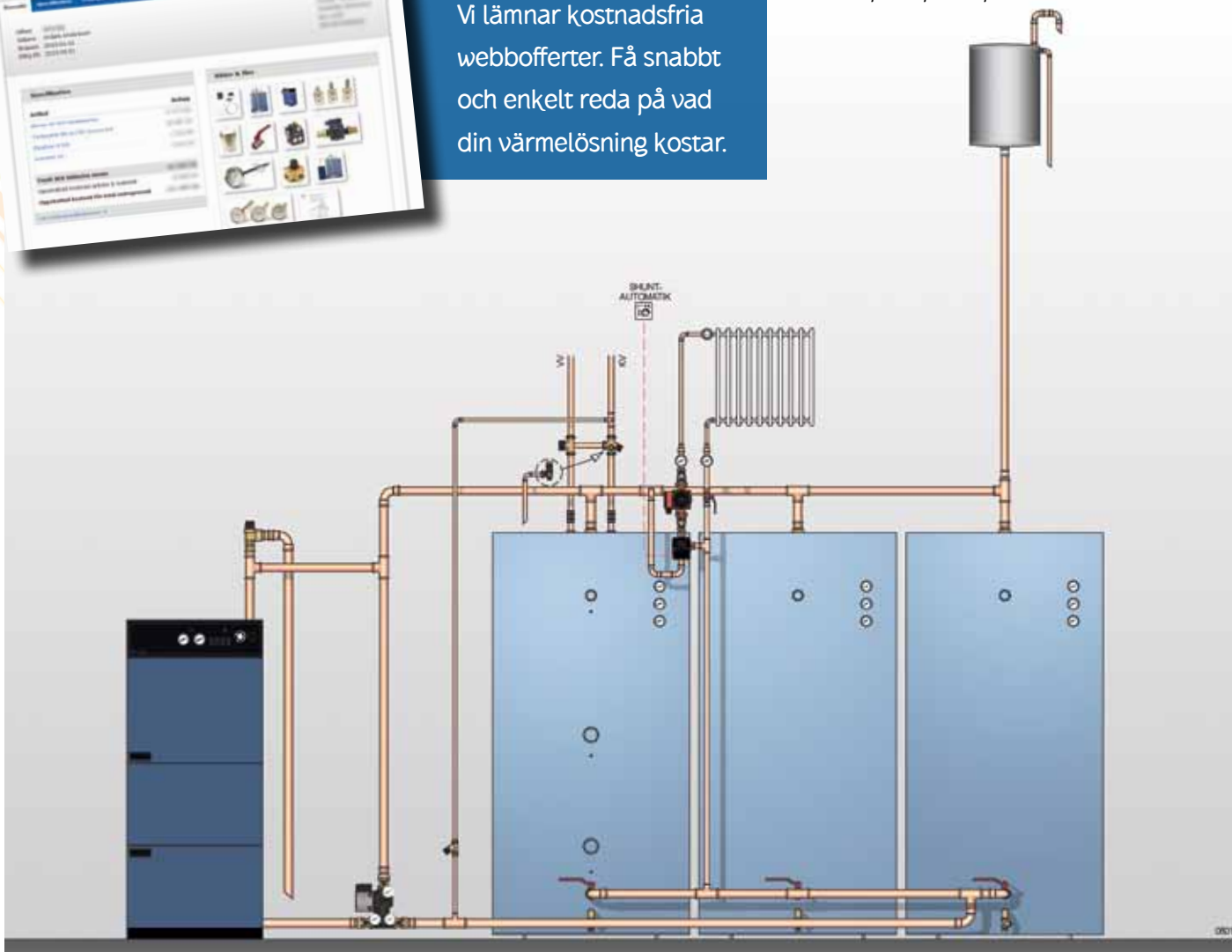
Principskiss på tankpaket med 3 st tankar
