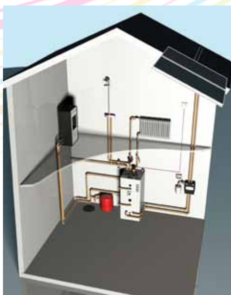
Principskiss vattenmantlad pelletskamin – solvärme
