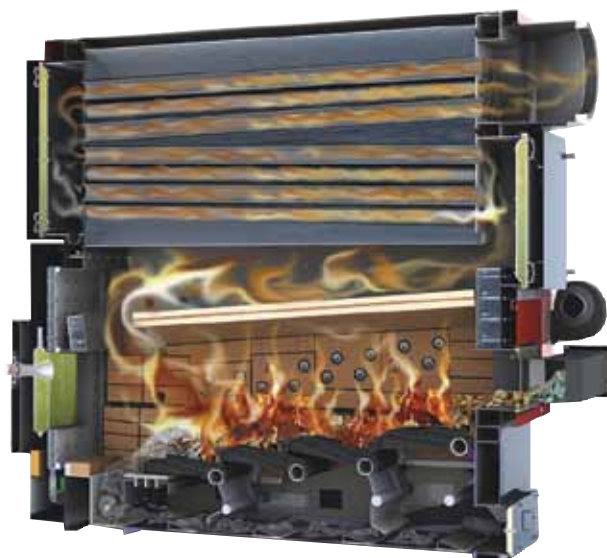
Tack vare det zonindelade trappstegsrostret kan pannan använda många olika biobränslen utan att brännarkammaren behöver förändras fysiskt.
