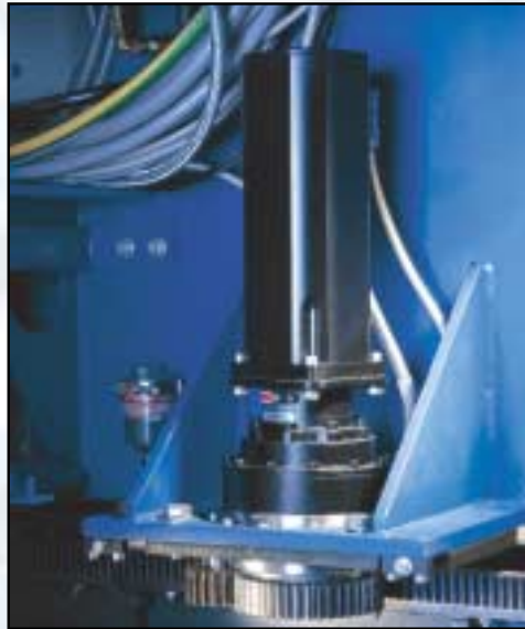
Hochgenaue Linearführungen in Längs- und Querrichtung kombiniert mit wartungsfreien AC-Motoren sorgen für Schnelligkeit und Präzision. Highly accurate longitudinal and transverse linear guidance combined with maintenance free AC servo motors ensure speed and precision.
