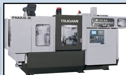
FMA5-III , horisontell FMS-fleroperationsmaskin för 5-axligt utförande och upp till 20 paletter.
