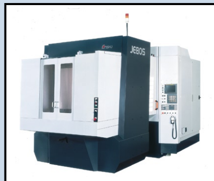
JE80S , horisontell lerop med bl.a. snabbtransport 90 m/min och acc. 1G
