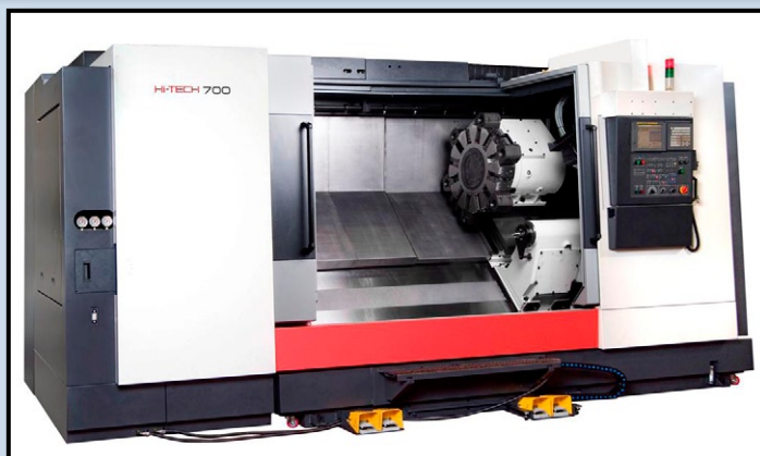
Hi-Tech 700 , cnc-svarv med bl.a. 2 m svarvlängd, svarvdia 700 och drivna verktyg. Kyld spindelocka och termisk kompensering är standard. Maskinen vikt ca 15 ton.
