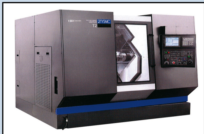
T2 , moduluppbyggd cnc-svarv med en eller två spindlar, en eller två revolverar, drivna verktyg och Y-axel.
