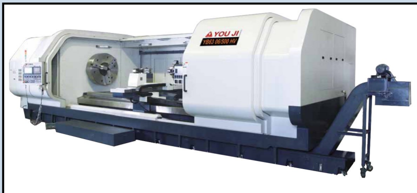
You Ji tillverkar flera typer av horisontella svarvar, ovan visas YB-serien som finns med svarvlängd upp till 6 m och swing över bädd 1600 mm.
