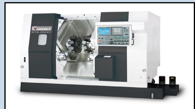
GTS-2600XY , GTS-serien, som har dubbla revolverar, dubbla spindlar och även dubbla Y-axlar (tillval), kan bearbeta två detaljer i en uppspanning.
