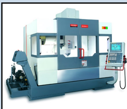
MV204CPL , kraftfull vertikal flerop, XYZ = 1500x700x610. Finns även med BT50.
