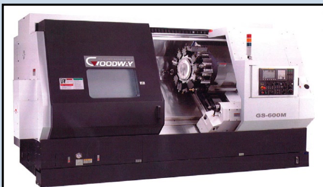
GS-600 har ett swing på 980 mm och svarvdia på 880 mm, finns i 3 längdutförande upp till 3300 mm svarvlängd.
