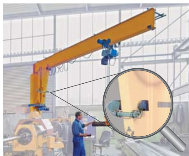
Gränslägesbrytare för svängmaskineri (bild 6)
