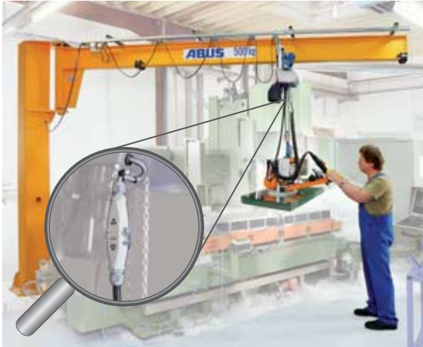
Svängkran med vakuumutrustning med extra anslutningskontakt (bild 13)
