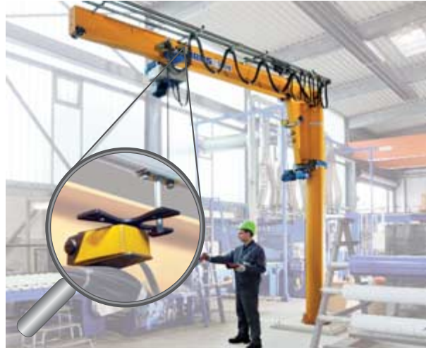
Gränsbrytare för elektriskt telferåverk (bild 8)
