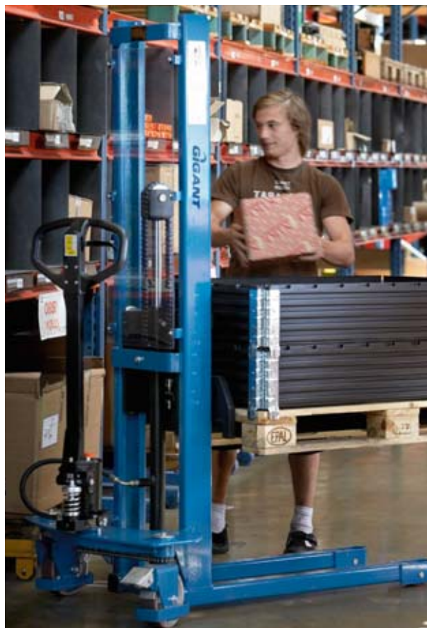
Smidig staplare med snabblyft. Kan även användas som lyftbord.
