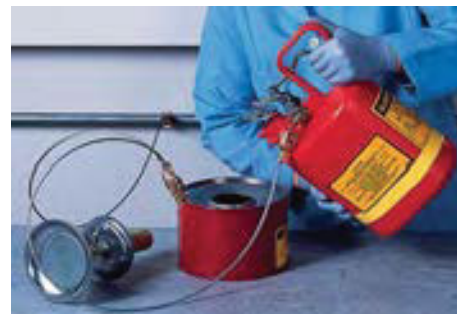
Jordning med antistatiska kablar
