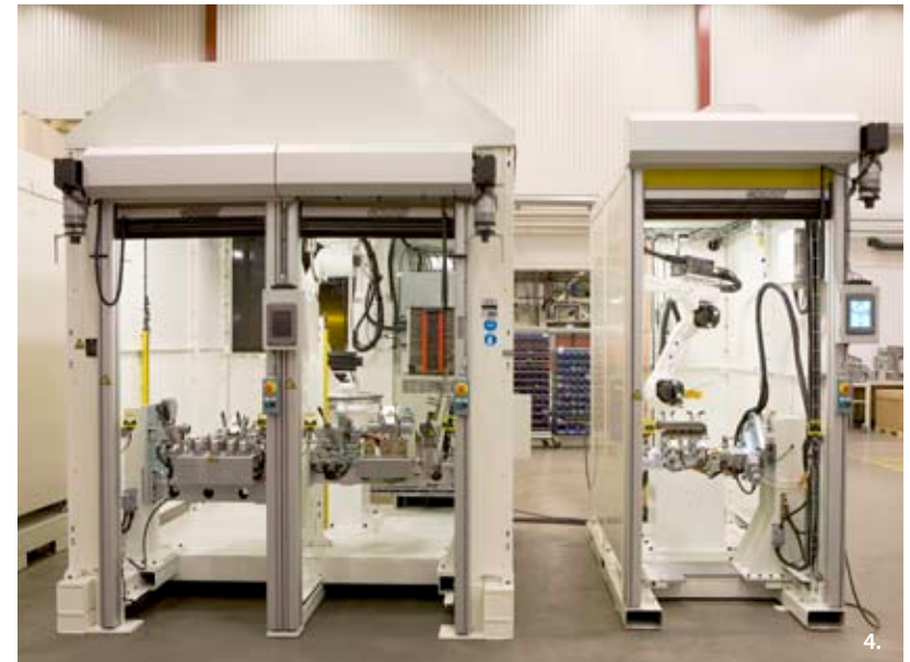
Lång erfarenhet av automation bäddar för enkla lösningar med fokus på funktion. 1. Robotsvetsfixtur på vagn för enkla fixturbyten. 2. Punktsvetsmaskin. 3. Elektrisk formningsmaskin. 4. Dubbel/enkel robotsvetscell, byggda på fundament för enkel hantering med truck.
