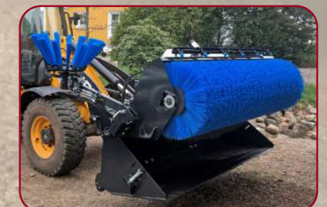
Sopskopen töms genom att lyfta upp borstrotorn och sen tippa skopen
