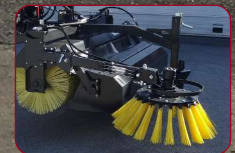
Sidoborste med mekanisk uppfällning och tre olika inställningsmöjligheter
