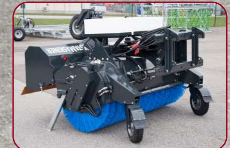
Stabila runtomsvängande massiva stödhjul och uppfälld uppsamlingsbox
