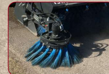
Sidoborste som kan mixas med stål- och nylonborst
