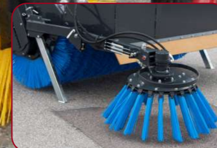
Sidoborsten går att använda även med uppfälld box
