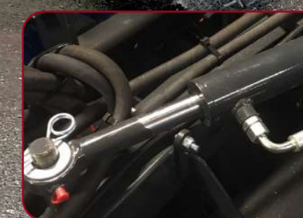
Hydraulisk justering borstvinkling (Tillval)
